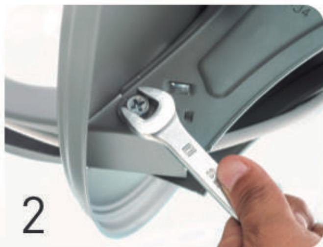
2) Ajusta ambos tornillos del brazo con la llave de 11mm o 7/16" para que quede firme.
